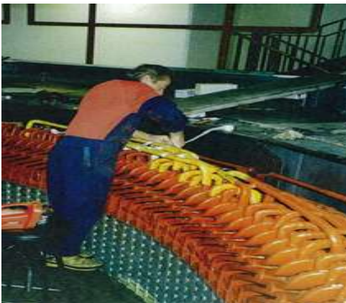
RÉPARATION DE LA PROTECTION DE BAS
