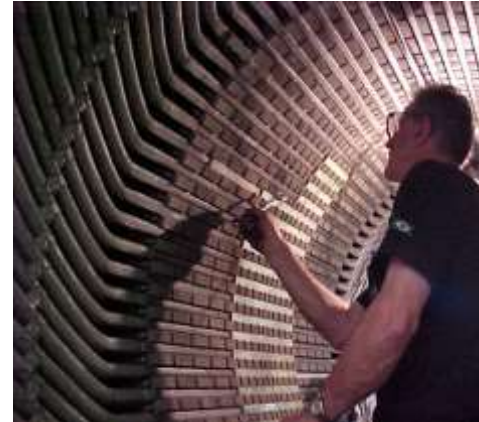
RECALAGE DU STATOR
