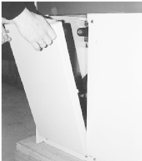
1. Dévisser les panneaux d'accès aux câbles, puis inclinez les légèrement et tirer.
