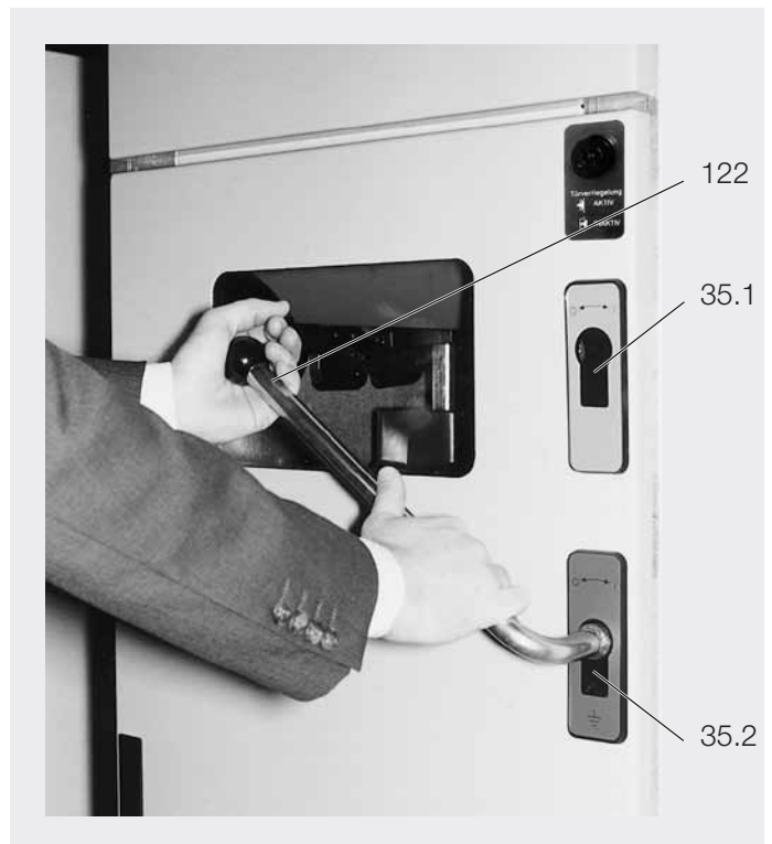
Bild 6/8: Betätigung des integrierten Erdungsschalters und der automatischen Schiebeplatte am Schaltfeld der Klassifizierung LSC 2A - PI. 35.1 Antrieb Lasttrennschalter 35.2 Antrieb Erdungsschalter und automatische Schiebeplatte 122 Schalthebel
