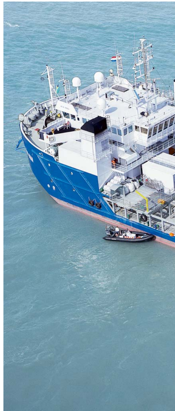
Mit der 86 m langen „Topaz Installer“ werden die Seekabel verlegt. Außerdem ist es an Bord des Schiffs möglich zu „jointen“, das heißt Kabelabschnitte zu verbinden.
