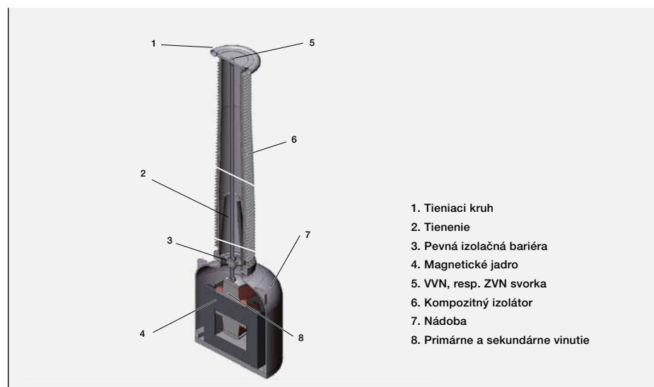
2 Konštrukcia transformátora TIP
