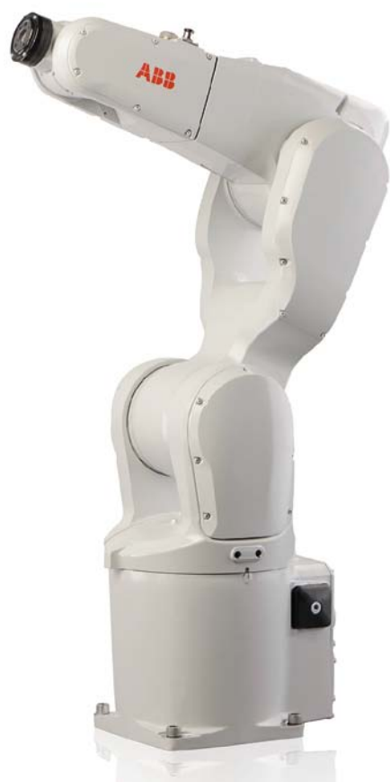
IRB 1200 je v ponuke v dvoch variantoch: s dosahom 700 mm a nosnosťou 7 kg, alebo dosahom 900 mm a nosnosťou 5 kg
