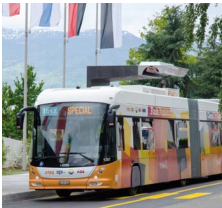
4 Technológia ABB na bleskové dobíjanie dokáže nabiť akumulátory autobusu za 15 sekúnd
