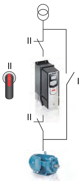
A Situación normal: la carga es alimentada a través del variador.
