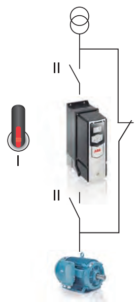
C Situación de Bypass, el variador es aislado de la alimentación, pero al mismo tiempo la carga es conectada directamente a la alimentación
