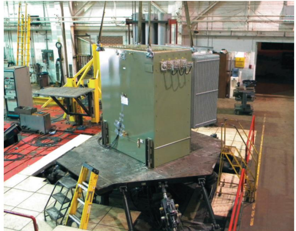
Ensayo de mesa vibratoria de un transformador 3000 KVA bajo standard IBC
