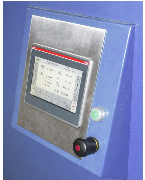
Das ABB CP635 Touchscreen-Bedienpanel auf einer Wifag-Druckmaschine
