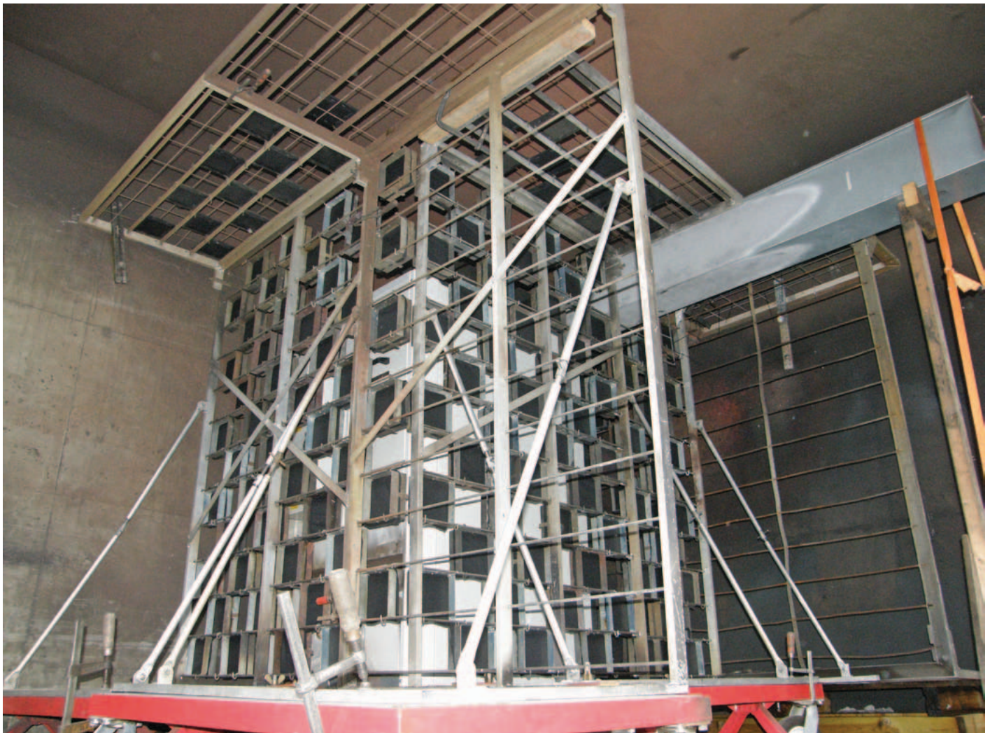
Struktur für die Prüfung der Störlichtbogensicherheit
