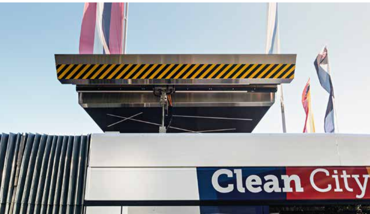
— SAUBER UND SCHNELL: HIER LÄDT DER TOSA INNERT NUR 15 SEKUNDEN MIT 600 KILOWATT NACH. DAZU FÄHRT AUTOMATISCH EINE STROMZULEITUNG AM DACH DES Busses AUS.
