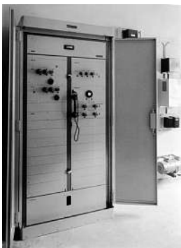
Eine von ABBs ersten Kommunikationsinstallationen, ca. 1944. Die Ausrüstung erlaubte es Netzbetreibern, Signale über ihre Stromleitungen zu übermitteln.
