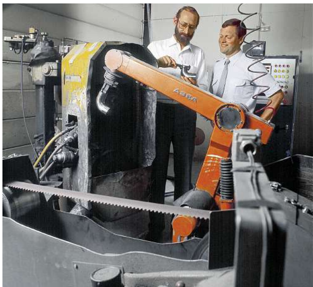
1974 wurde Magnusson AB der erste externe Roboter-Kunde von Asea. Die Firma setzte den Roboter ein, um rostfreie Stahlröhren für die Nahrungsmittelindustrie zu polieren.
