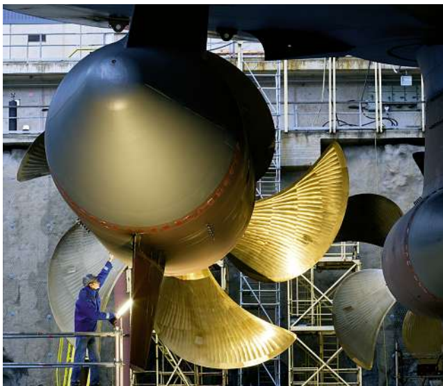
Eine Azipod-Einheit im Trockendock, 2009. Die Gondel enthält einen elektrischen Motor, der den Propeller antreibt, was an Bord Platz für zusätzliche Fracht oder mehr Kabinen schafft.
