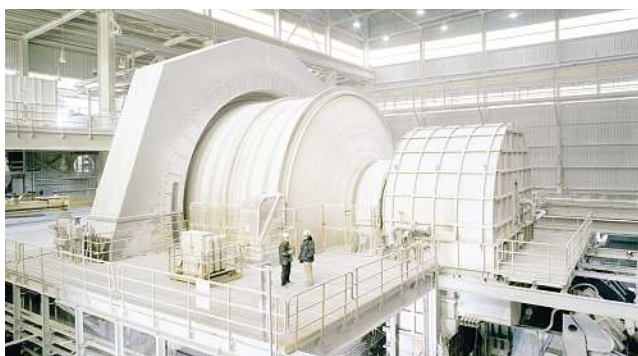
Die Collahuasi-Kupfermine im Norden von Chile verwendet mehrere von ABB-Energie- und Automationsprodukte, inkl. des grössten getrieblosen Mühlenantriebs (im Bild) und des Systems 800xA, um den Betrieb zu optimieren.
