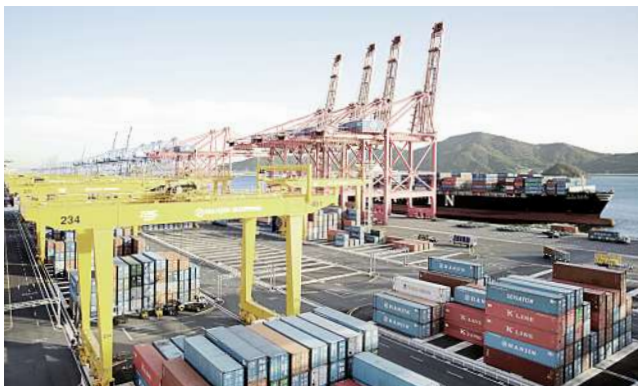
Doppelwinden-, Ship-to-shore-Kräne und automatisierte Brückenkräne auf Schienen am Busan New Port in Südkorea, 2009 von ABB installiert.
