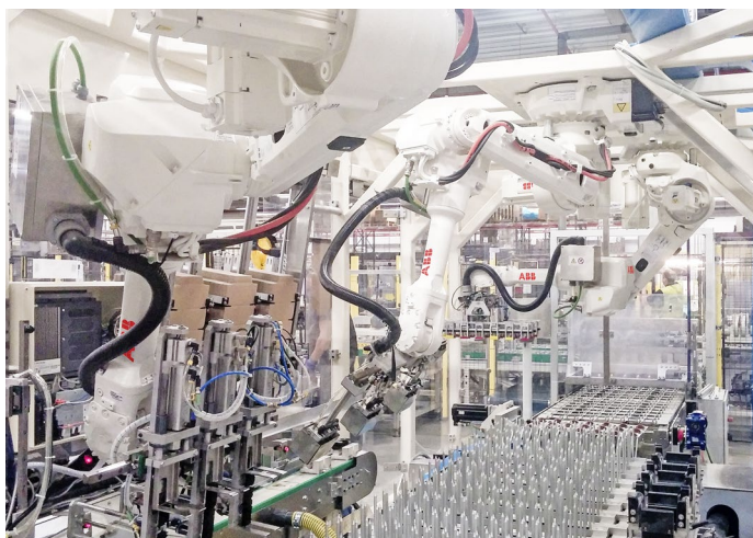
Les robots ABB emballent des piles sur une installation entièrement automatisée
