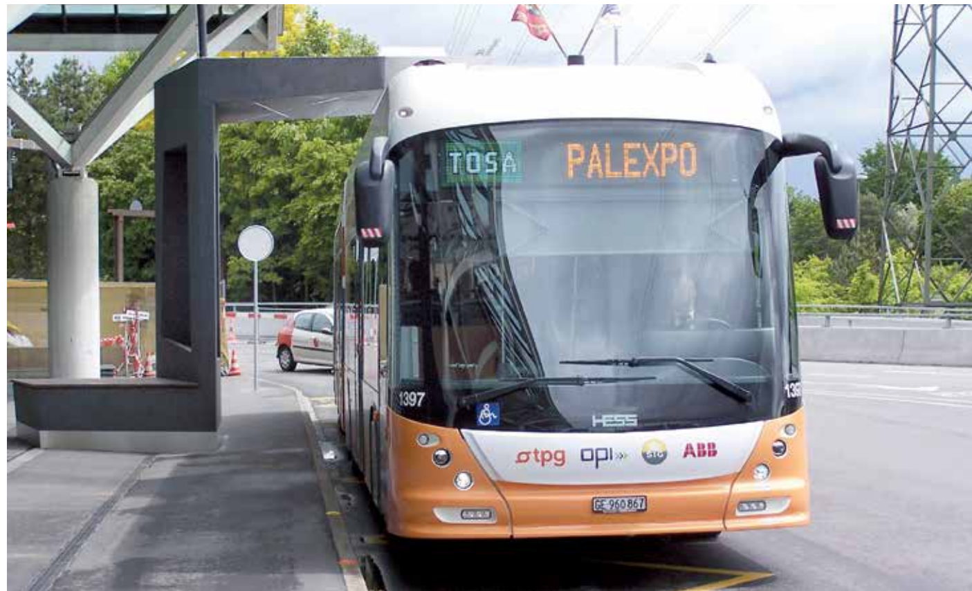
Technologia błyskawicznego ładowania oraz pokładowe wyposażenie trakcyjne wykorzystywane w projekcie zostały stworzone przez ABB i zoptymalizowane na potrzeby tras, na których autobusy kursują z dużą częstotliwością, przewożąc w godzinach szczytu znaczną liczbę pasażerów. (Fot. Hoff1980/Wikipedia)
