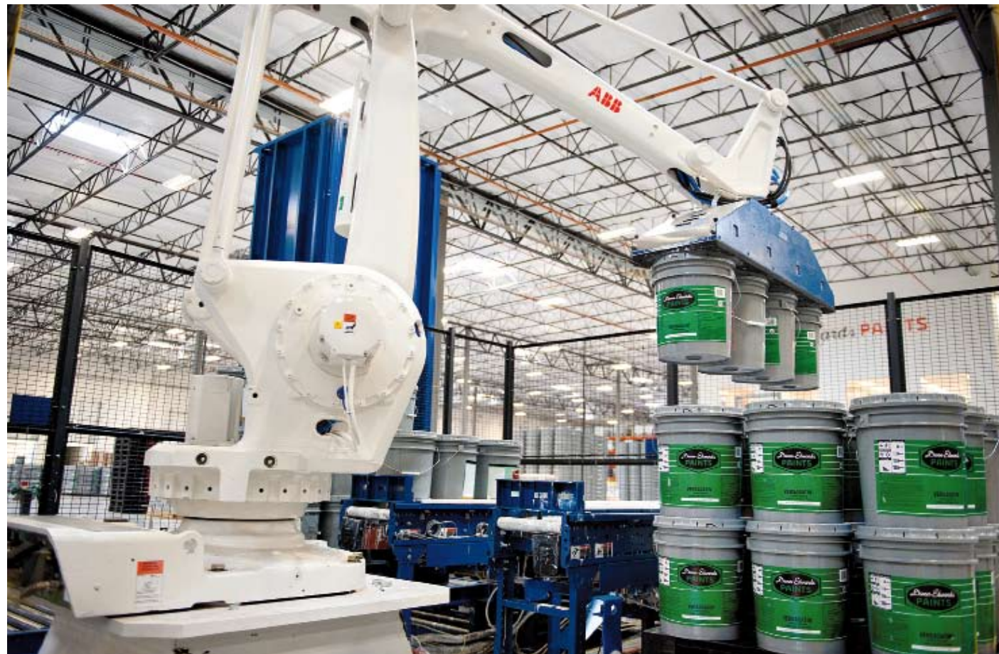
Paletyzacja ciężkich worków, kartonów czy pojemników to zadanie dla robota. ABB stara się, by jego instalacja na linii produkcyjnej była możliwie prosta, tania i szybka. (Fot. Arch. ABB)
