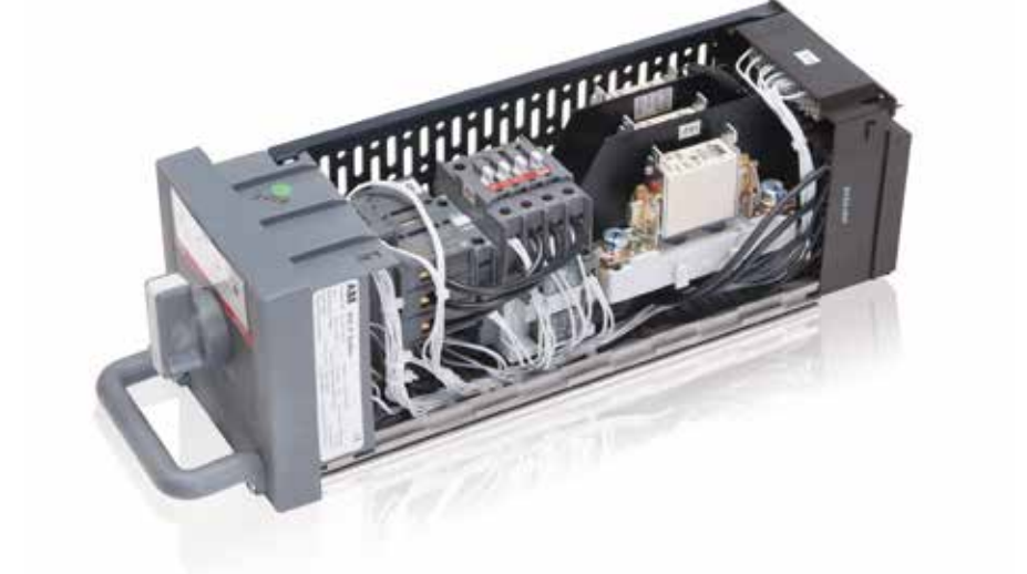
Moduły sterujące w rozdzielnic MNSiS są instalowane w oddzielnych przedziałach funkcyjnych, co pozwala na prowadzenie prac w przedziale sterowniczym bez niebezpieczeństwa dotknięcia obwodów siłowych będących pod napięciem.
