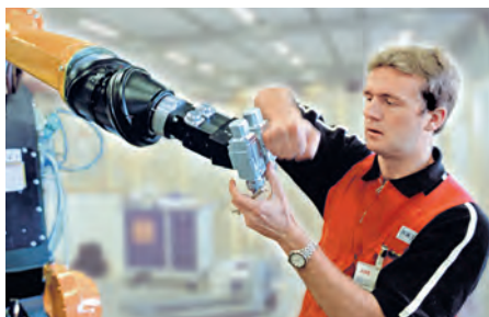
Finaler Test an einem Lackierroboter, der in Norwegen im Einsatz ist
