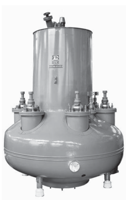
4b 采用钢制阀罐的大型汞弧阀。这一 2,500 A、2,000 kW 的汞弧阀产于 20 世纪 50 年代，重达 1,235 kg，高度超过 3 m。
