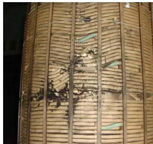
图 2 绕组的烧蚀及变形
