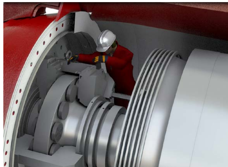
Рис. 3-5 Упорный подшипник гибридного типа. Замена вкладыша внутри модуля Azipod VI2300
