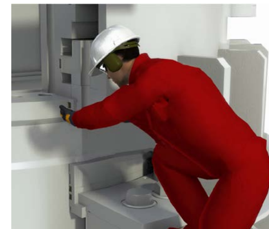
Рис. 5-2 Замена поворотных уплотнений через помещение Azipod, без сухого дока (Рулевой модуль серии I4000)
