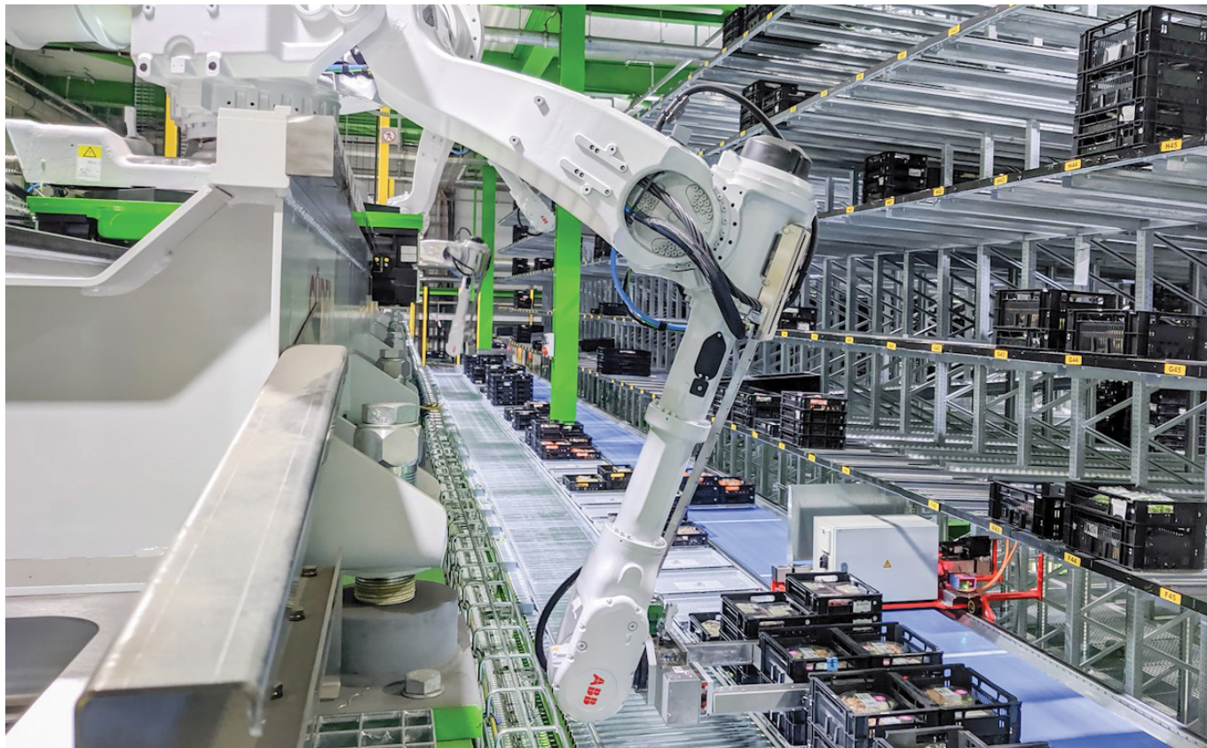
Роботизированное решение для сборки заказов на производстве компании Heemskerk в Рейнсбурге (Нидерланды) формирует заказы по запросу от каждого супермаркета или компании, занимающихся розничной торговлей продовольственными продуктами. Таким образом, продукты питания могут напрямую отправляться на прилавки супермаркетов без ожидания в распределительных центрах.
