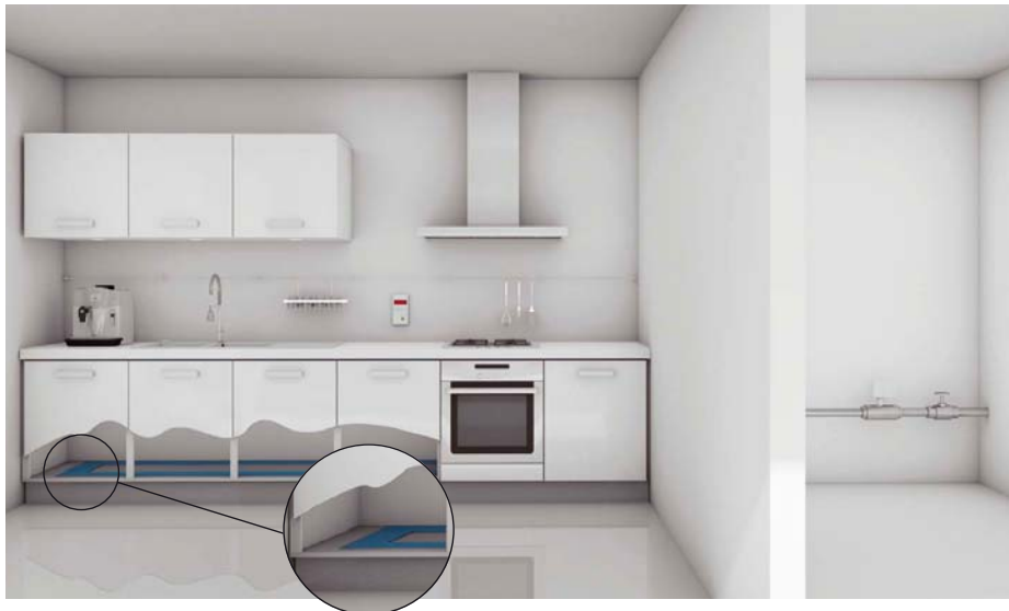
Príklad využitia systému v kuchyni – v prípade pretečenia drezu vyššie páskový snímač, umiestnený v skrinkách pod drezom, signál modulu, ktorý aktivuje alarm a uzavrie prívod vody
