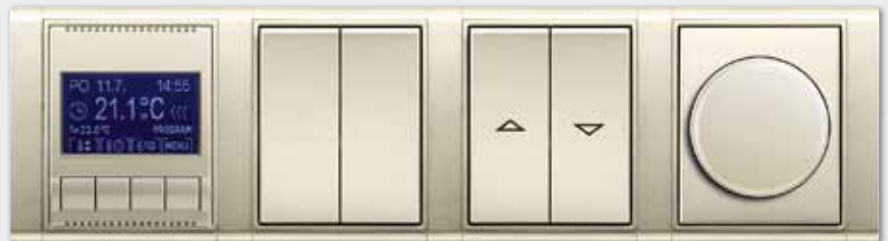
obr.2 Termostat univerzálny programovateľný (celkom vľavo je digitálny termostat v dizajne Time® v kombinovanom vyhotovení – má pripojený snímač teploty, ktorú sníma v podlahe kvôli ochrane elektrických rohoží – vo farbe Starostrieborná) vo viacrámčeku s ďalšími prístrojmi: Prepínač sériový / ovládač dvojité / prepínač striedavý dvojité, Spínač / ovládač žalúziový, Stmievač s otočným ovládačom.
