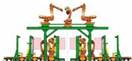
4 GateFramer umožňuje zváranie a montáž až 6 modelov áut na jednej linke
