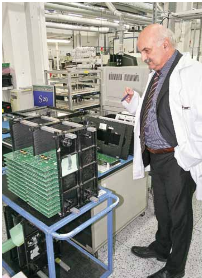
2, 3, 4 Výrobný program závodu zahŕňa prevažne malé série spínaných zdrojov – od malých vo forme plošných spojov až po objemné skrine
