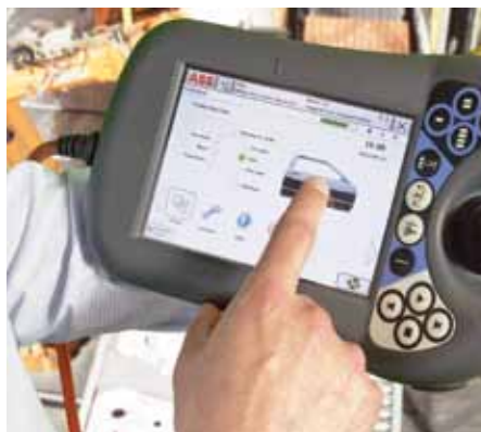
2 Softvér umožňuje operátorovi účinne komunikovať s robotom bunky cez FlexPendant
