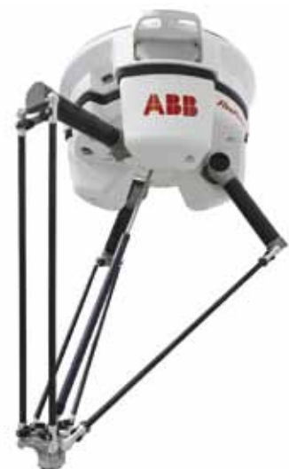
3 IRB 360 s nosnosťou 8 kg a dosahom 1130 mm
