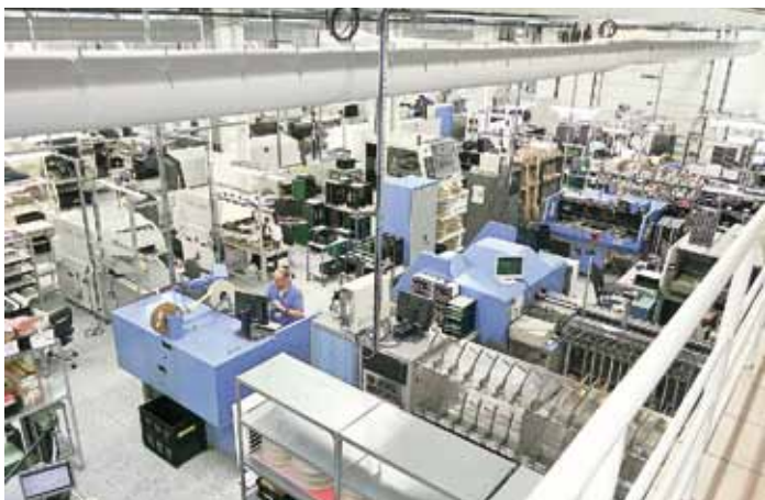
2, 3, 4 Výrobný program závodu zahŕňa prevažne malé série spínaných zdrojov – od malých vo forme plošných spojov až po objemné skrine
