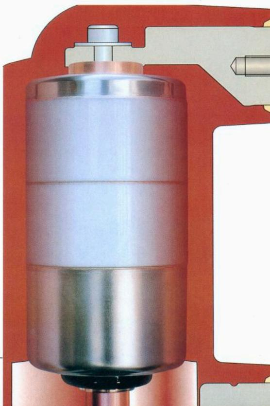
Vzhľadom na extrémne nízky statický tlak v zhášacej komore 10,4 až 10,8 mbar, pre dosiahnutie vysokej elektrickej pevnosti postačuje relatívne malá medzera medzi kontaktmi. Oblúk horiaci vo vákuu zhasne už pri jednom z prvých prechodov prúdu nulou.
