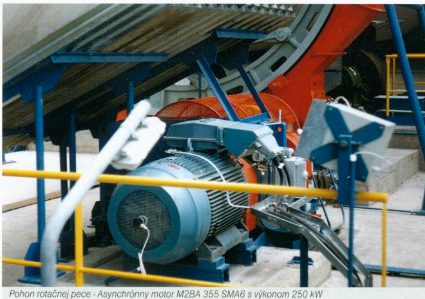
Pohon rotačnej pece - Asynchrónny motor M2BA 355 SMA6 s výkonom 250 kW
