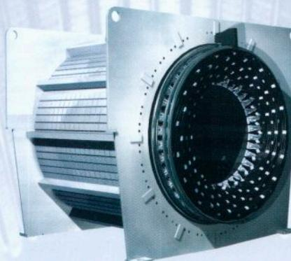
Vyššia spoľahlivosť Motorformera je daná tiež faktom, že prúd tečúcich káblami je proporcionalne znížený, takže mechanické sily pôsobiace medzi káblami sú takisto úmerne menšie. V prípade skratu nie sú vodiče namáhané veľkými silami a pravdepodobnosť poškodenia vinutia je tak oveľa nižšia.
