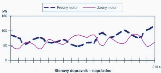
Stenový dopravník - naprázdno
