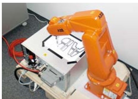
Aj najmenší robot IRB 120 predvádzal svoju presnosť s trochu neštandardným nástrojom – fixkou.
