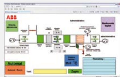
1 Operátor nastavuje žiadané teploty v miestnostiach a otáčky frekvenčných meničov pre jednotlivé okruhy
