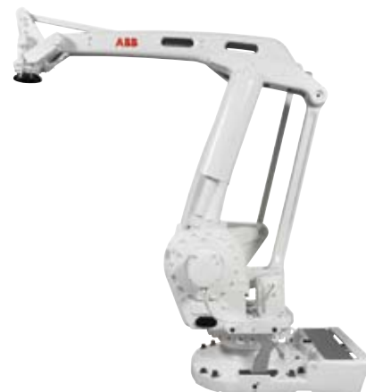
6 IRB 660 obsluhuje aj štyri odberné dopravníky
