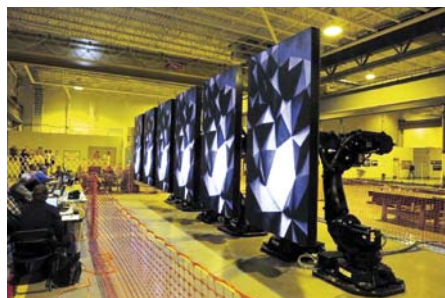
Videooobrazovky pripevnené na robotoch ABB smerujú na palubu lodí Royal Caribbean
