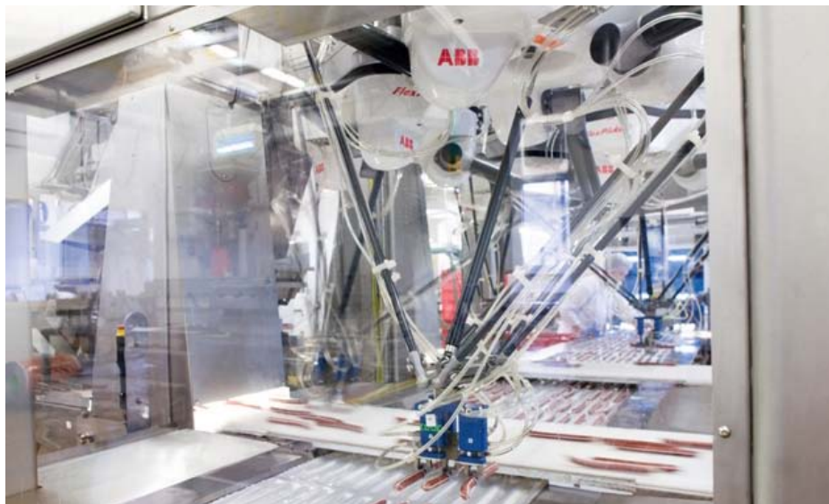
2 Označenie Clean room znamená, že komponenty robota nemôžu kontaminovať nezakryté alebo citlivé výrobky, ktoré sa vyrábajú v čistých priestoroch
