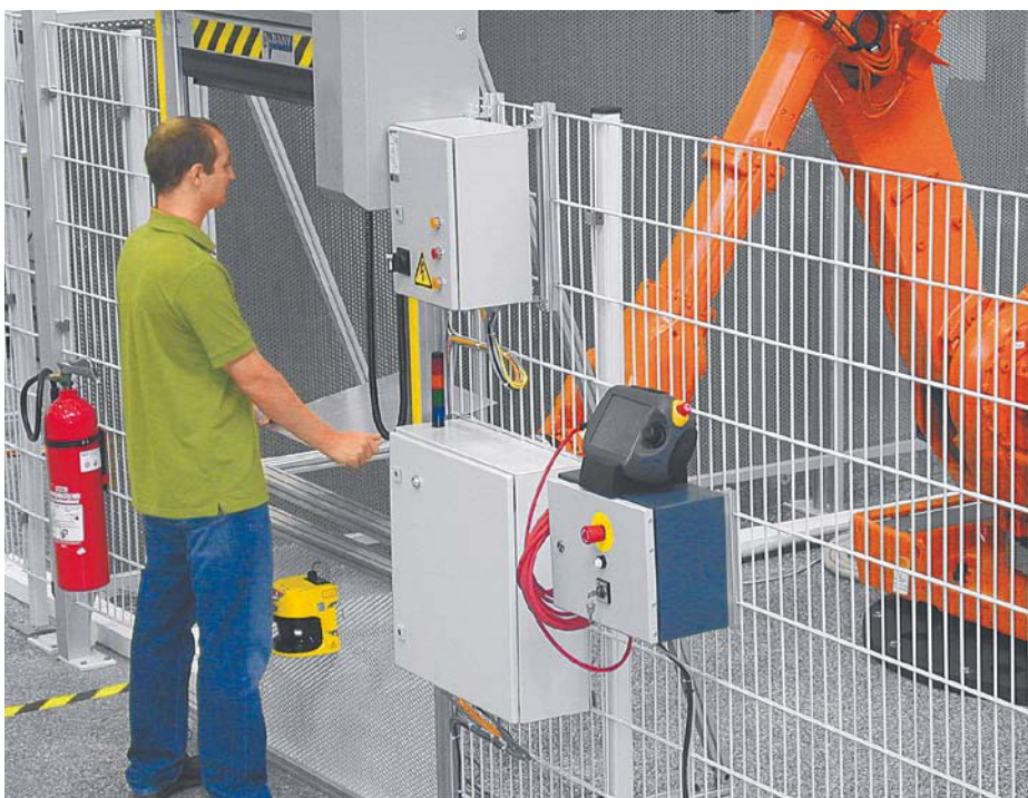
SafeMove môžete použiť na zníženie nákladov pri stavbe oplotenia robota
