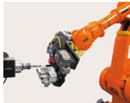
Obr.6 Robot so snímačom, upínačom a vretenom pripravený na odstrappovanie
