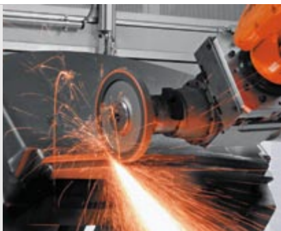
Obr.5 Proces brúsenia, počas ktorého robot spomalil, ak narazí na neúmerne drsný povrch. Merané prítláčnej sily prekročí nastavenú hodnotu, čo je signál pre robot, aby spomalil. Keď sa veľkosť sily zníži, robot zrýchli na zadanú rýchlosť v čase 0,1 s
