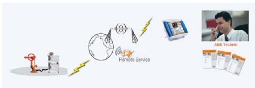
Obz. Ak má robot poruchu, tak automaticky alarmuje centrálu, ktorá technikovi odošle SMS
