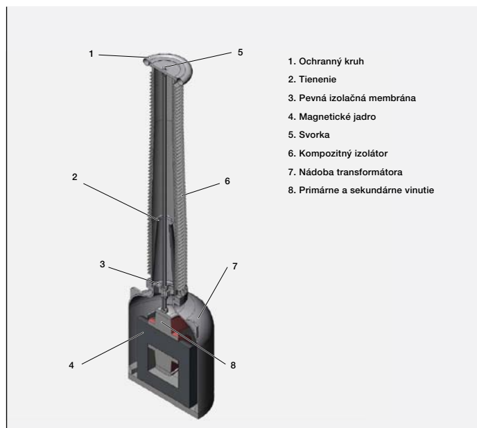
1 Vnútrná konštrukcia transformátora TIP
