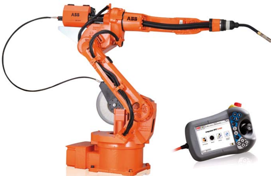
1 Robot IRB 1520 s kompletne integrovanou zváracou kabelážou a FlexPendant s integrovaným riadením zváracieho procesu
