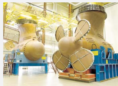
Pre nový ľadoborec ruskej spoločnosti Rosmorport dodá ABB výkonné hnacie a energeticky efektívne elektrické systémy Azipod, ktoré vedia elektrickú energiu využívať efektívne aj pri teplote -35 °C v dvojmetrovom ľade.
