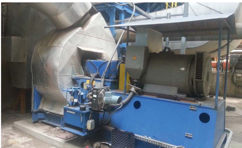
1 Ventilátor s pôvodným 450 kW VN motorom pracoval mimo odporúčanú pracovnú oblasť s katastrofálnou účinnosťou
