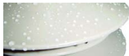
Vodoodpudivý povrch izolátora z HCEP
