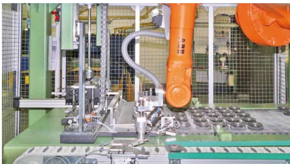
1 Robot IRB 1600 umiestňuje keramické podložky a surové diely na ne s vysokou presnosťou
