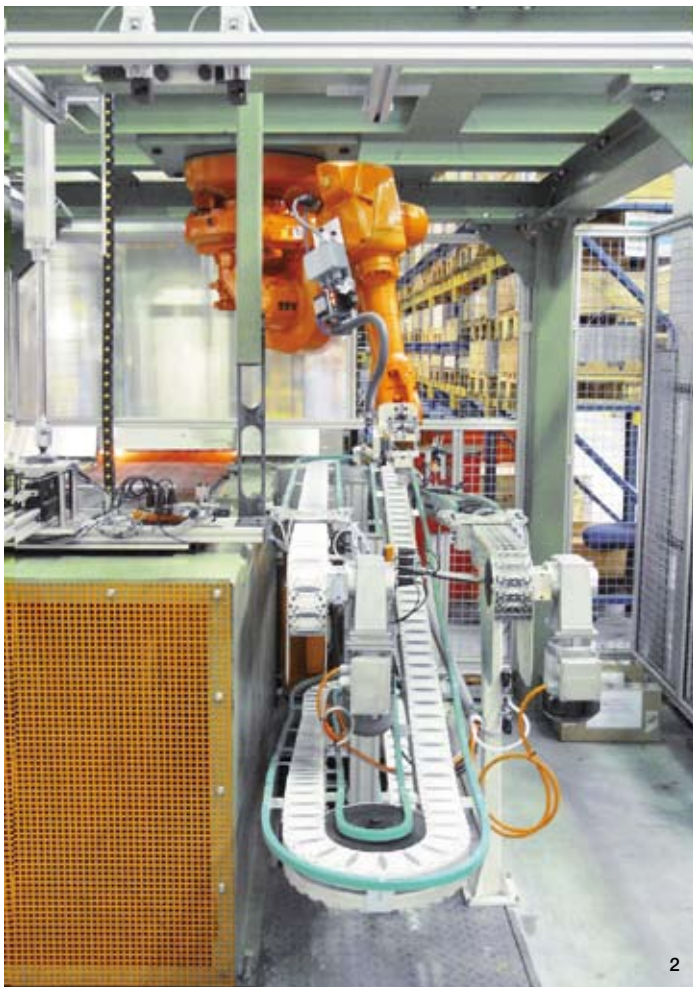
2 a 3 Pohľad do vnútra robotizovaného pracoviska s robotom IRB 1600 inštalovaným zo stropu 4 Celkový pohľad na pracovisko a riadiacu jednotku
