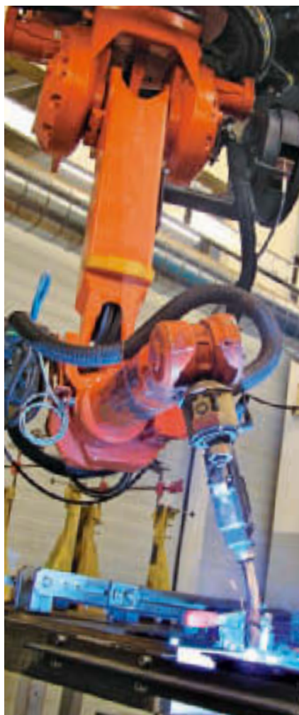
Obr.3 Robot urobí dlhý zvar „ako podľa pravítka“
