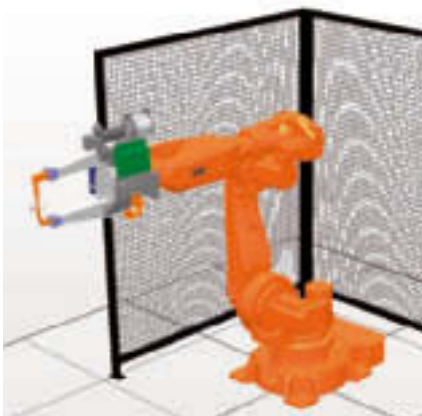
Obr.4 Rad IRB 6600 – určený na vysoké zaťaženie a veľké výkony (vizualizácia)
