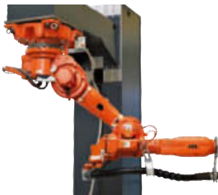
Obr.1 Invertované umiestnenie robota – variabilita umiestnenia a nízka hmotnosť rozširujú možnosti nasadenia
