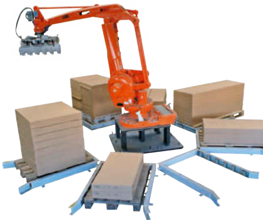
Obr.2 Paletizačné pracovisko s robotom ABB IRB 660 spracúva až 7 druhov výrobkov naraz
