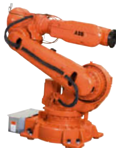
Obr.2 Robot je schopný operovať aj zo šikmého podkladu, čo zvyšuje dosažiteľnosť pod základňu robota
