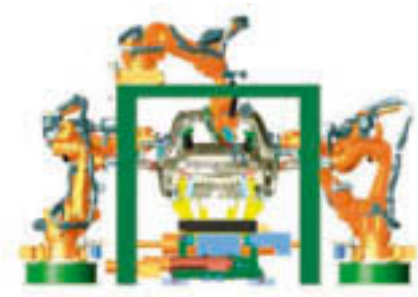
Obr.3 Umiestnenie robotov nad seba znižuje priestorové nároky linky
