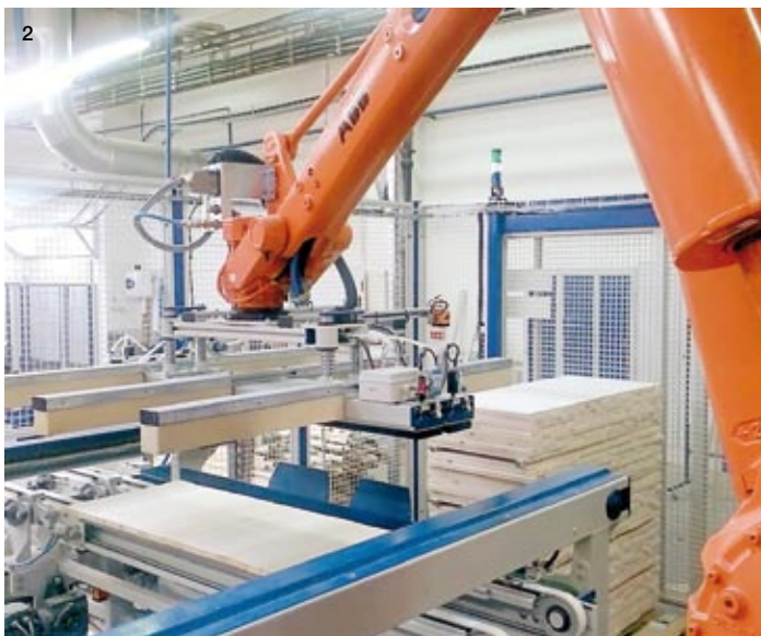
1 Pôdorys riešenia obsluhy kontinuálneho lisu dvoma bunkami s robotmi ABB IRB 660 | 2 Robot ABB IRB 660 s gripprom na nakladanie polotovaru do kontinuálneho lisu | 3 IRB 660 upravený na odoberanie už zlisovaného polotovaru
