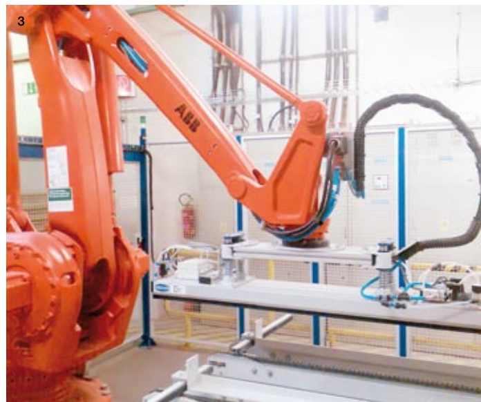
1 Pôdorys riešenia obsluhy kontinuálneho lisu dvoma bunkami s robotmi ABB IRB 660 | 2 Robot ABB IRB 660 s gripprom na nakladanie polotovaru do kontinuálneho lisu | 3 IRB 660 upravený na odoberanie už zlisovaného polotovaru
