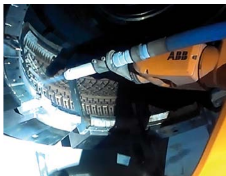
Robot ABB IRB 120 sa pomocou konštrukcie umiestni priamo do lisu a formu dokonale vyčistí
