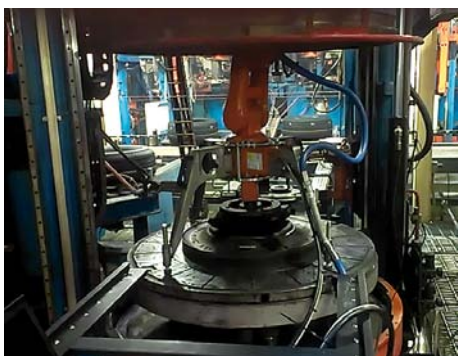
Robot ABB IRB 120 sa pomocou konštrukcie umiestni priamo do lisu a formu dokonale vyčistí
