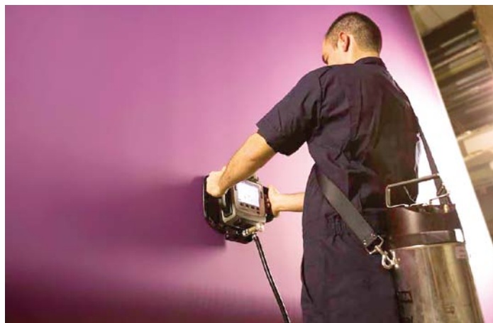
3 Profilové meranie obsahu vody s L&W Felt Permeability Meter
