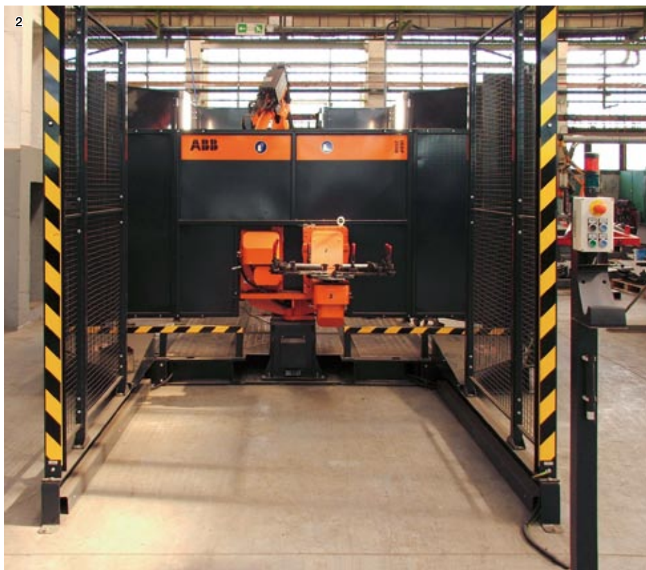
2 Kým polohovadlo č.2 čaká na naloženie v logistickom priestore vpredu, za zástenu robot IRB 2400L zvára polotovar na polohovadle č.1
