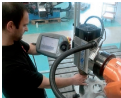
Obr.3 Chytiť robot a rukou ho dotiahnuť na želané miesto – to je možnosť, o ktorej programátori robotov mohli doteraz len snívvať
