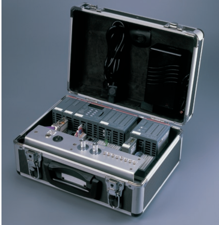
Obr.1 Nový PLC systém ABB – AC 500 vo verzii tzv. Demo výukového vybavenia
