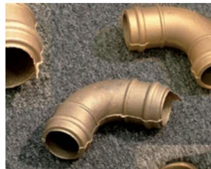
Obr.2 Aj odchýlky v rozmeroch odliatkov sú príčinou nepresnosti pri tradičnom opracovaní
