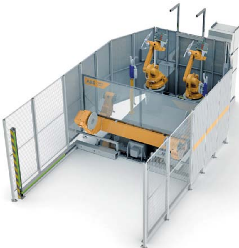
2 Zváracia bunka FlexArc vybavená dvoma robotmi a polohovadlom na minimálnej ploche
