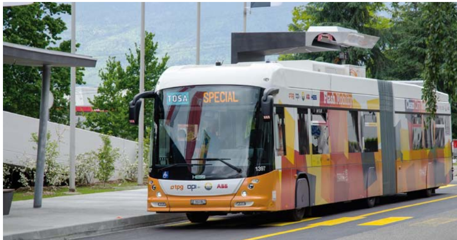
1 Elektrobus TOSA si počas nástupu/výstupu osôb dobil batérie pomocou ramena na streche
