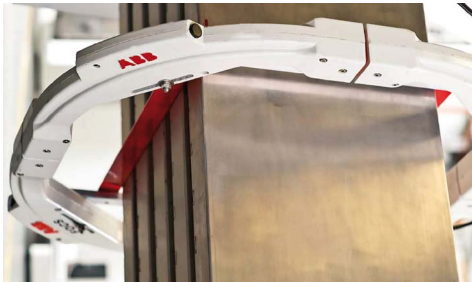
2 FOCs na meranie DC prúdu zberníc
