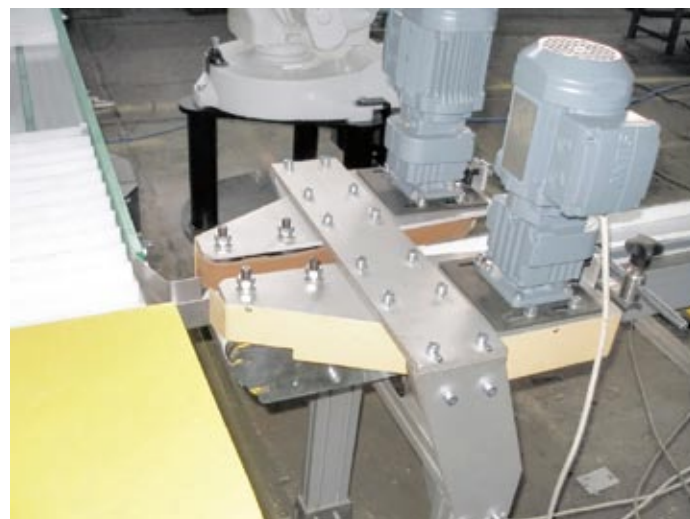
1 Odovzdávanie výrobkov z vyrovnávacieho dopravníka do Racer track dopravníka
