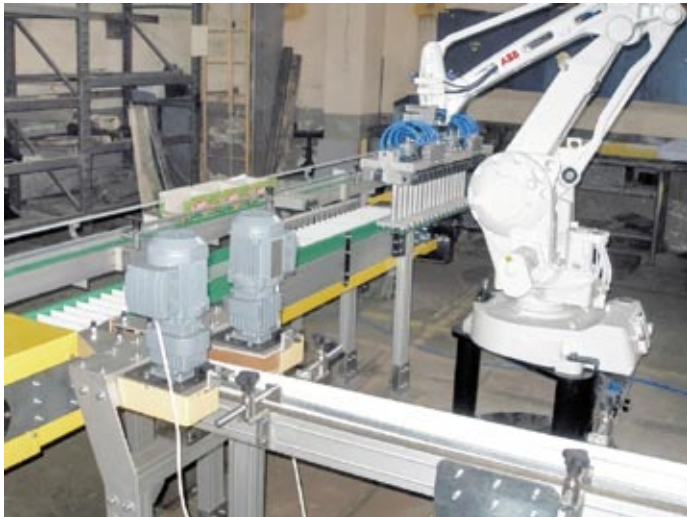
2 Odoberanie produktov robotom a plnenie produktov do zásobných unášačov
