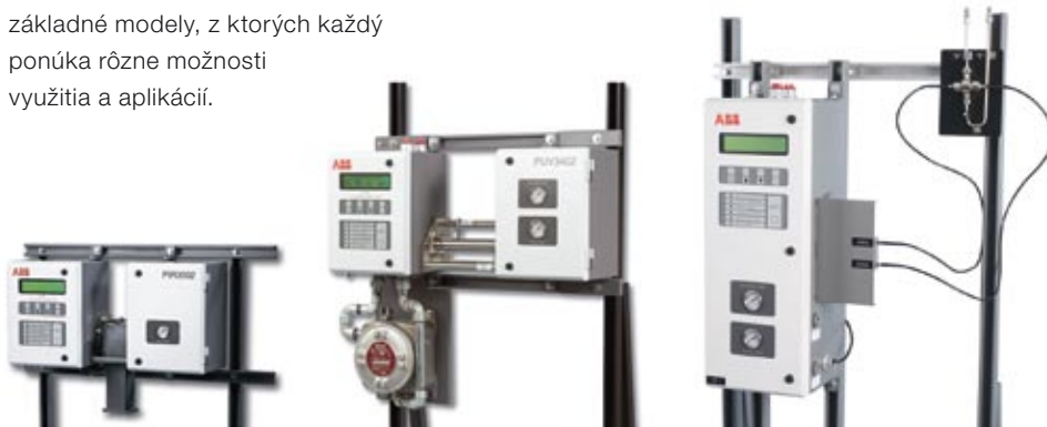
1 Procesné fotometre Multiwave™ na rôzne aplikácie – PIR3502 pre meranie v oblasti infračerveného žiarenia, PUV3402 pre oblasť viditeľného a UV žiarenia a PFO3502 s oddelenou komorou a optickými vláknami pre špeciálne aplikácie s vysokotoxickými alebo korozívnymi látkami
