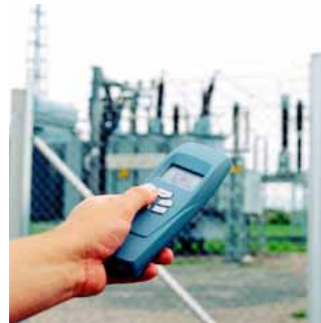
4 Diaľkové odčítanie údajov z bezpečnej vzdialenosti
