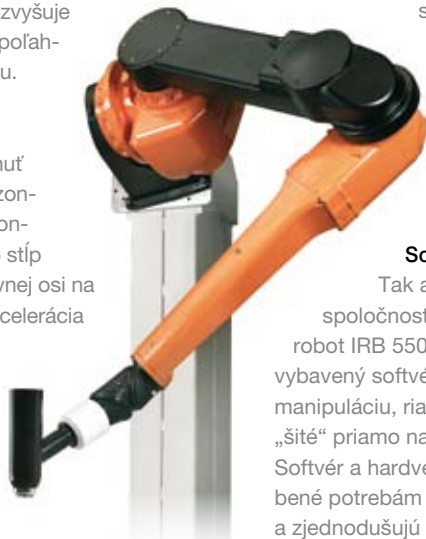
Obr.1 FlexPainter – unikátna konštrukcia a flexibilita
