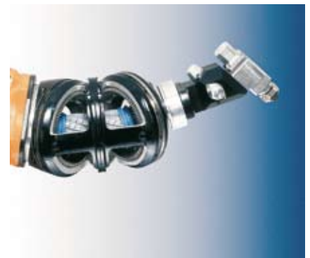
Obr.2 Hollow wrist – konštrukcia zápastia robota
