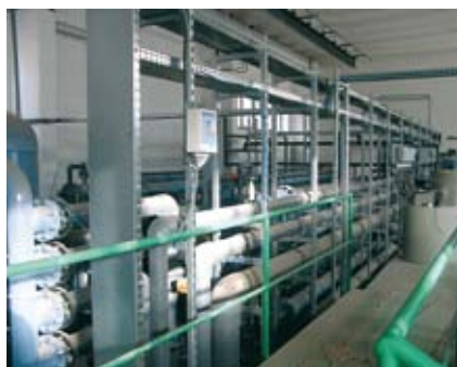
Obr.1 Voda sa upravuje reverznou osmózou
