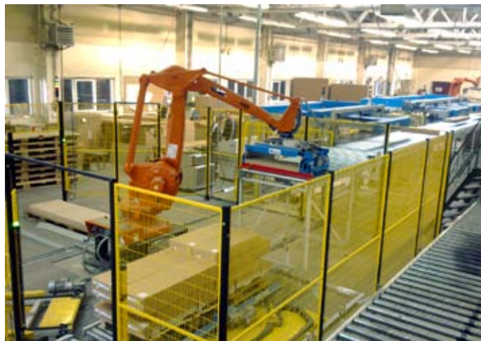
4 Robot ABB IRB 660 vytvára paletu kombi výrobkov
