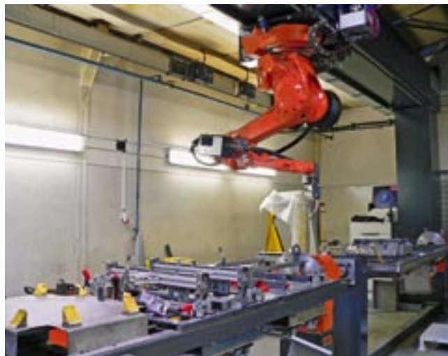
Robotizované zväzacie pracovisko na výrobu trezorov vo firme EK, s. r. o.
