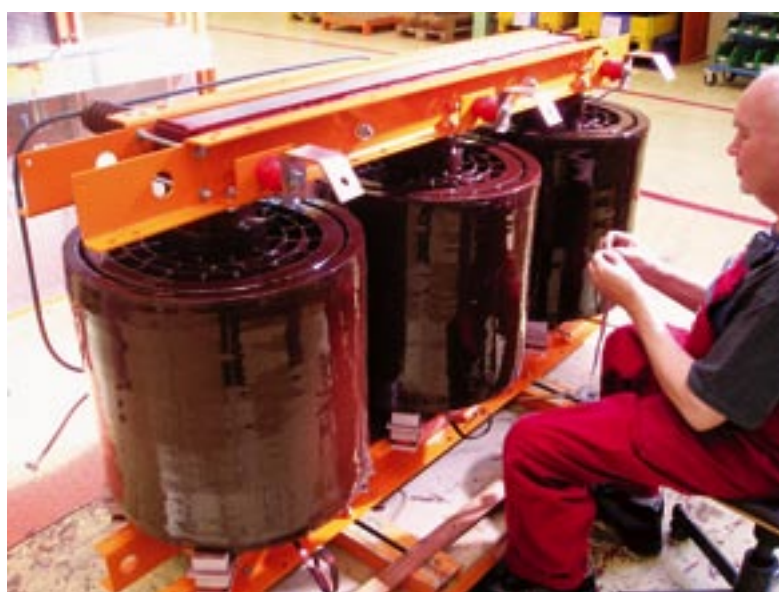
1 Transformátor typu RESIBLOC® 50 kVA, 22/0,4 kV, Dyn11 vo výrobnej hale pred ukončením a zakrytovaním
