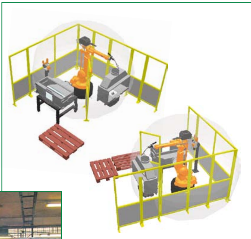
2 Zväracie pracovisko vo fáze projekcie – RobotStudio
