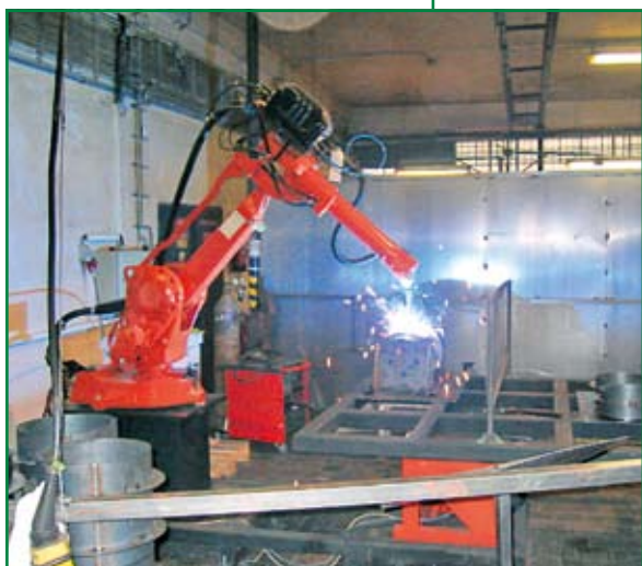
1 AWC umožňuje robotu zvarenec si vopred „ohmatať“
