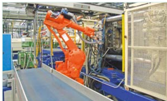
2 Obsluha lisu Demag manipulačným robotom ABB IRB2400
