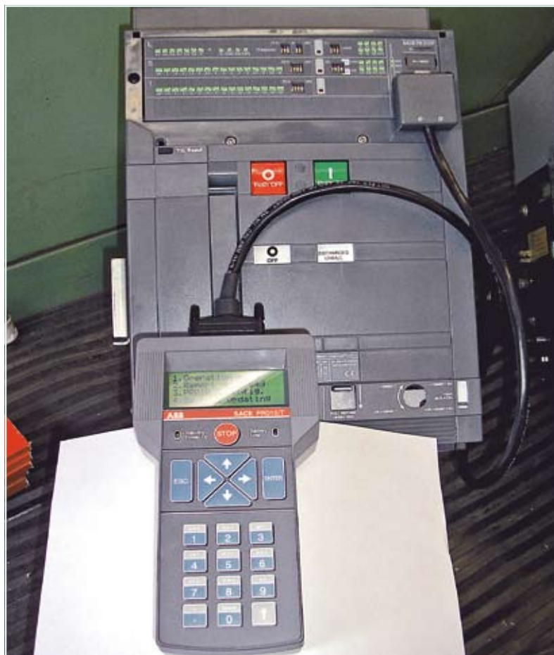
2 Testovacia jednotka SACE PR010/T pri diagnostikovaní spúšte SACE PR121/P
