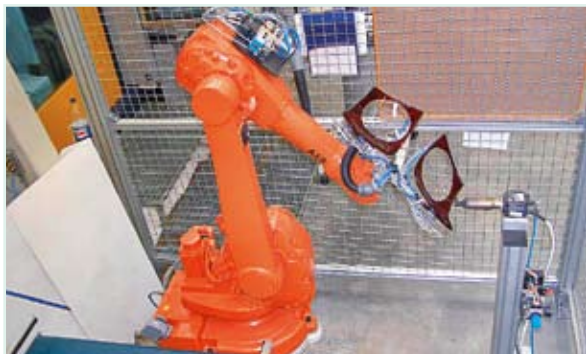
1 Robot ABB IRB1600 s opaľovacím zariadením
